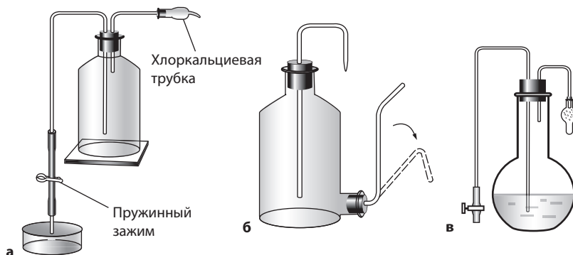
Рис. 3.18. Емкости для хранения дистиллированной воды: а – бутылка с хлоркальциевой трубкой; б – бутылка с тубусом; в – колба с защитой от поглощения \text{CO}_2 .
